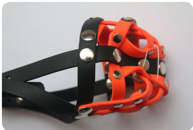
Abb. 2: Mit Hilfe von Nylonfäden simulierter und fixierter „Knautsch-Effekt“ bei einem Biothane-Maulkorb / “Crumple effect” of biothane muzzle (simulated and fixed with nylon threads)
